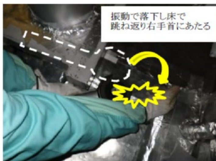
災害発生時状況写真(再現)
